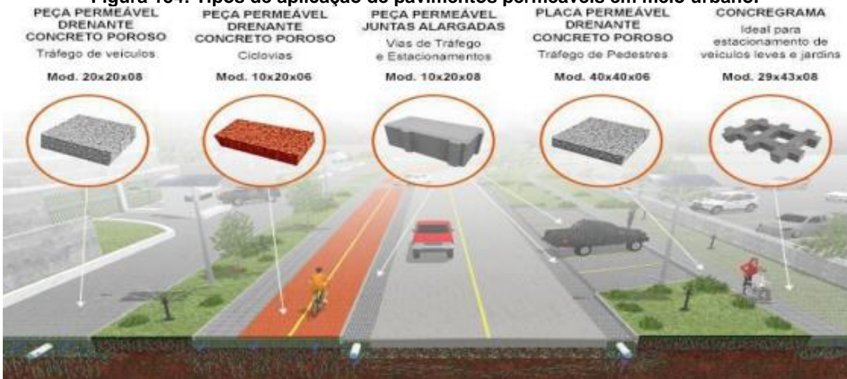
Figura 154: Tipos de aplicação de pavimentos permeáveis em meio urbano.
